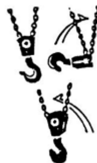
Рис. 6 Неправильное положение крюка.
