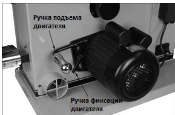
Рис. 36: ослабление натяжения ремня
